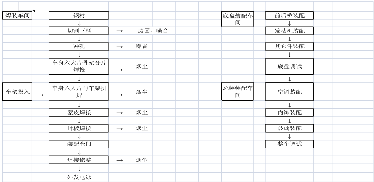
图 3.4.1 客车制造工艺流程及产污环节图
